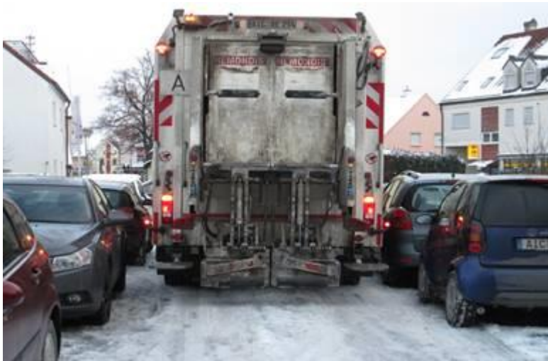
Abbildung 2 Rückwärtsfahrt bei Schnee um Kurve mit überhängender Hecke im Einmündungsbereich und beidseitigen Parken in enger Straße – die Hecke wurde mittlerweile entfernt und ein einseitiges Parkverbot erlassen
